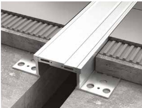
Joint structurels par système à glissement, fabriqués totalement en aluminium. Conçus pour permettre les mouvements structurels des bâtiments de grandes dimensions ou d'ensembles de bâtiments. Installés dans les espaces libres entre deux parties dissociées d'un même bâtiment ou entre deux travées différentes. Ils réunissent ces espaces intermédiaires en permettant des mouvements verticaux, horizontaux et de déplacement, causés par les tassements du bâtiment, d'une façon ponctuelle ou permanente.
